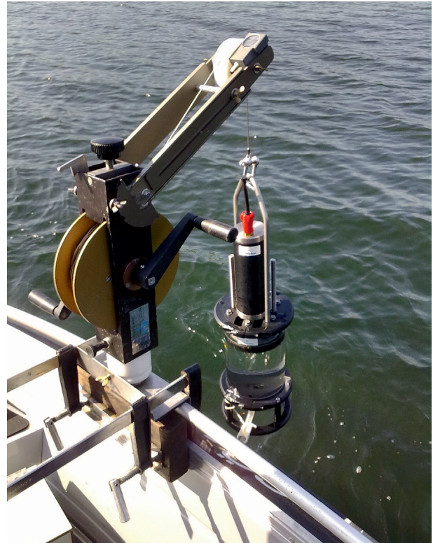
Abb. 4: Planktonprobenahme mit einem tiefenintegrierenden Wasserschöpfer.
