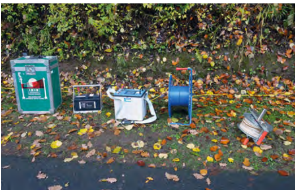
Abb. 2: Komponenten der geoelektrischen Tomografieapparatur: links: Stromversorgung, Messapparatur und Kabel, rechts: Beispiel für eine Messauslage
