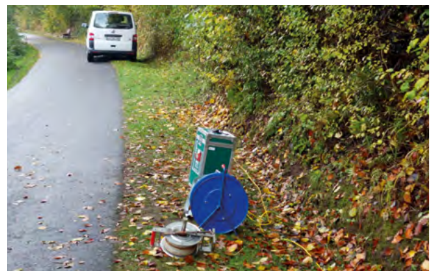
Abb. 2: Komponenten der geoelektrischen Tomografieapparatur: links: Stromversorgung, Messapparatur und Kabel, rechts: Beispiel für eine Messauslage
