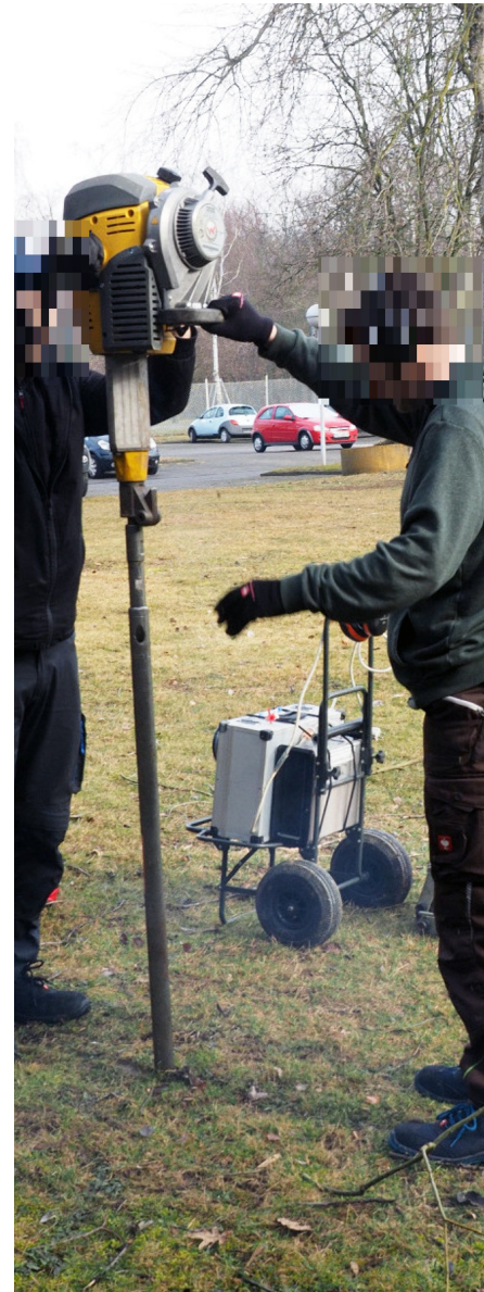
Abb. 3: Testmessung der THM im Gelände. Hier zu sehen ist der Bohrvorgang für die anschließende Radonbodenluftmessung. Im Hintergrund ist das Rotameter zu sehen, welches den Volumenstrom des Radongases misst.
