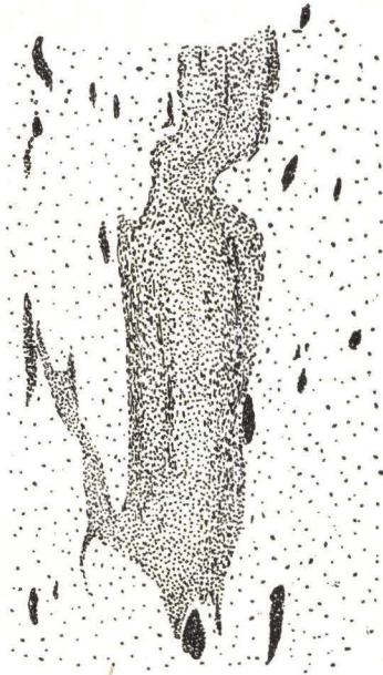
Fig. 2. Resorptionsschleier und der Auflösung widerstehende Schollen — „Basische Putzen“ — im schlierigen Granit. — Fürstenholz. — Gesamtlänge des dargestellten Stückes ca. 3 m.
