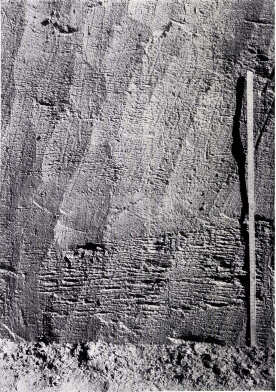
Basiszone des geschichteten Lößlehms in der Gräflichen Ziegelei Laubach. (Die Abbauwand war längere Zeit dem Regen ausgesetzt, so daß die einzelnen Schichten besser hervortreten. Maßstab 80 cm.)
