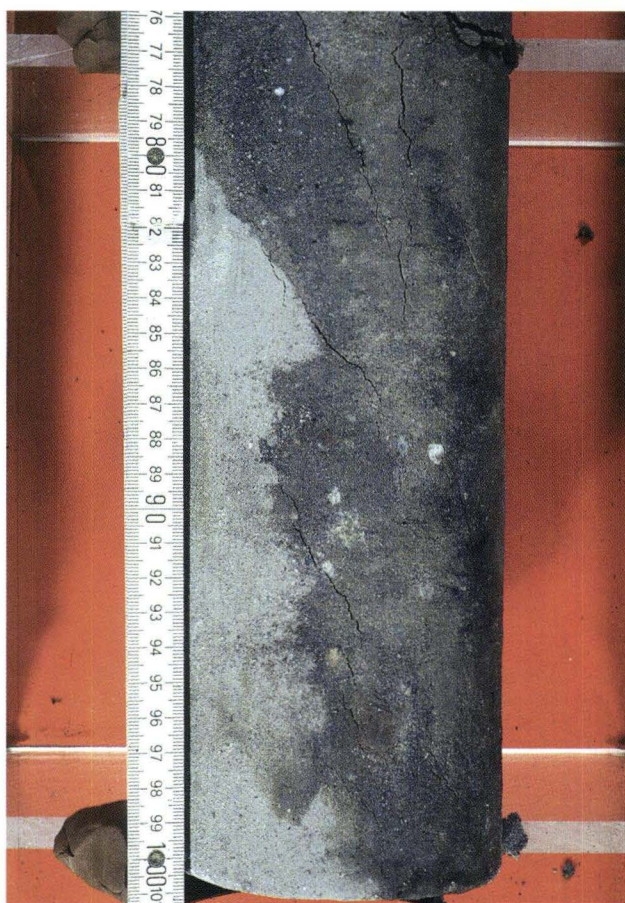
Abb. 5. Kernstrecke 55,76 bis 56,00 m in der Bohrung Sieblos 1999, einen Teil des phreatomagmatischen Ganges (bräunlich) und das kaolinitische Nebengestein (grau) zeigend.
