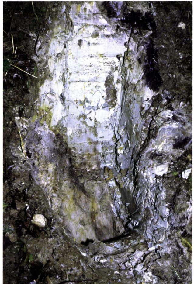
Abb. 7. Schurf IV (Tiefe etwa 80 cm) in den kaolinitischen Bildungen („Blauer Ton von Sieblos“) im Bachbett im Bereich der ehemaligen Grube Sieblos. Lage vgl. Abb. 6.
