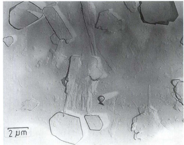
Abb. 5d. Hexagonale und rhomboidale Kaolinite, Aggregate aus leistenartigen Einzelkristallen und Anataskristalle (TEM, Replica).
