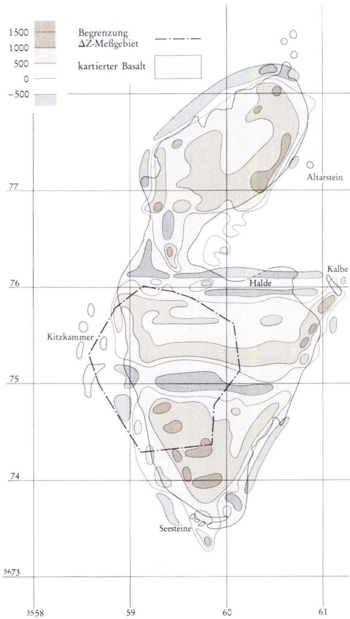
Abb. 6. Für das Modell berechnete Isanomalienkarte \Delta T , im umrahmten Gebiet \Delta Z , am Boden.
