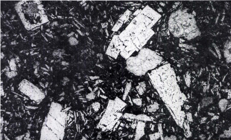
Abb. 6. Feldspatporphyrischer Diabas. — Einsprenglinge: Plagioklas, teilweise von Chlorit und Calcit verdrängt; Grundmasse: dünne Leisten von Plagioklas, Chlorit in unregelmäßig begrenzten grauen Feldern und dichte Zwickelfüllung aus Chlorit, Magnetit, Titanit und Titanoxid-Mineralen. — SE-Peripherie von Freienfels bei R 345039, H 559120; Bl. Weilburg. — Probe A 104, Dünnschl. H H 1426. — 15× —.
