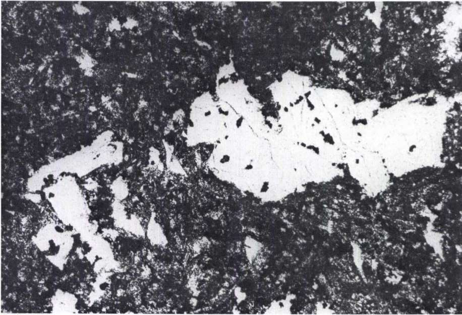
Abb. 7. Vermutlich vormalige Pyroxeneinsprenglinge, jetzt völlig chloritisiert, mit eingestreuten Titanit-Körnchen in feldspatporphyrischem Diabas; — ca. 45\times —.
