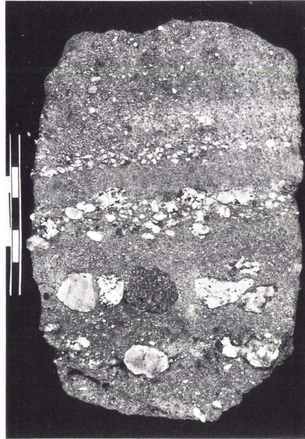
Abb. 33. Serir deposit (durch Ausblasung entstandene, lagenweise Geröllanreicherung in äolischem Sandstein); Bohrung W Dieburg (17; 56,95–57,05 m), (Maßstab 5 cm).
