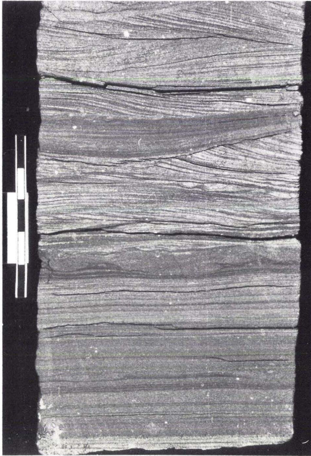
Abb. 32. Strömungsrippeln (oben), asymmetrische Oszillationsrippeln (Mitte) und Horizontallamination (unten): Bohrung W Dieburg (34; 14,64–14,74 m), (Maßstab 5 cm).
