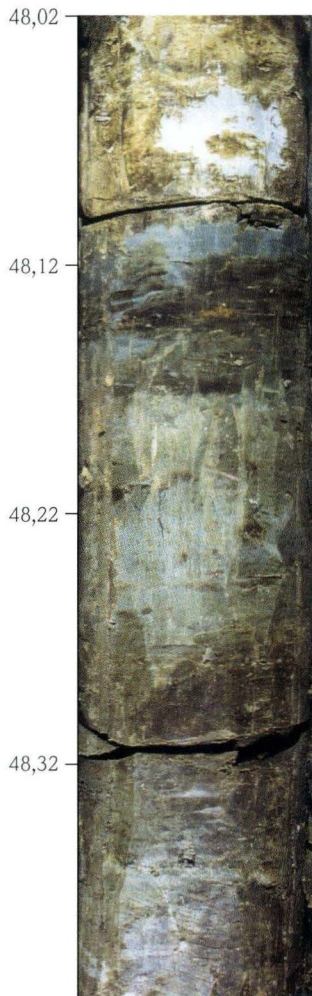
Abb. 2. Bohrung Wallau B98-BK5: 48,02–48,38 m: Wechsel von Tonmergel ( M_H ) (bis 48,10 m) zu horizontal geschichtetem Ton ( T_H ), olivgrün bis blaugrün (MPS).
