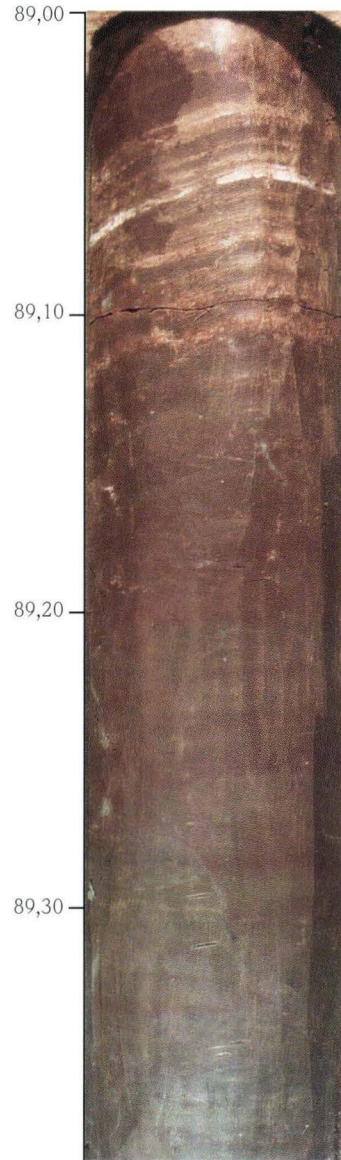
Abb. 10. Bohrung Wallau B98-BK5: 89,00–89,38 m: teils gut, teils schlecht geschichteter Tonmergel ( M_H ), rotbraun, mit koncretionärem Eisenkarbonat (MPS).
