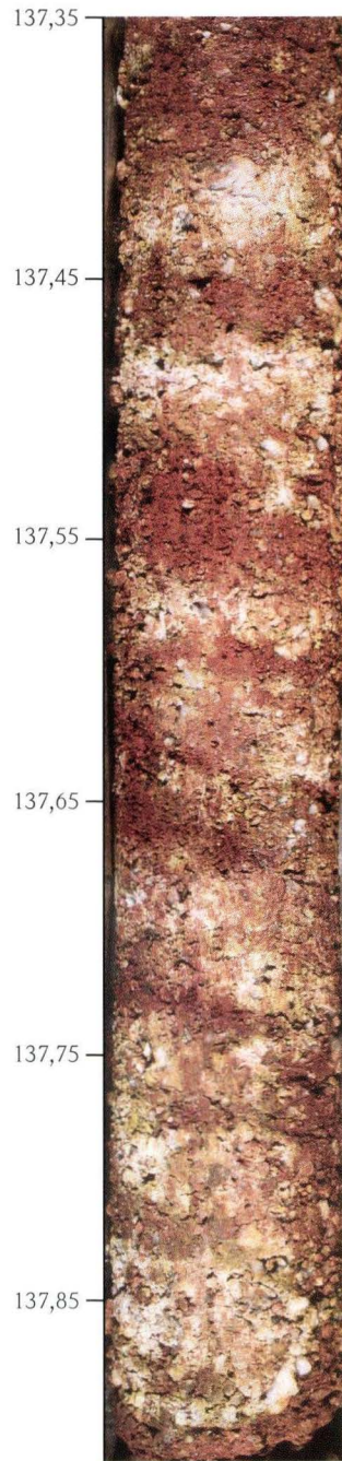
Abb. 14. Bohrung Wallau B98-BK5: 137,35–137,91 m: Grobkies ( K_G , K_R ), orange, rot- bis dunkelbraun, weiß mit Quarzit und Quarz (UPS).
