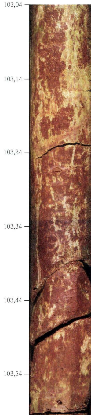
Abb. 7. Bohrung Wallau B98-BK5: 103,04–103,60 m: ockerbraun und braunrot, marmorierter Ton ( T_s ) (UPS).
