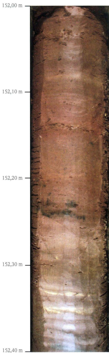
Abb. 2. Bohrung Wallau B98-BK5: 152,00–152,40 m: Tonstein mit Siltsteinlagen.
