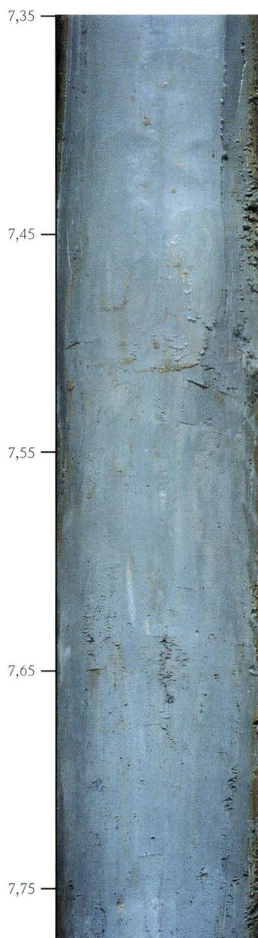
Abb. 4. Bohrung Wallau B98-BK5: 7,35–7,76 m: Ton ( T_3 ) mit den typischen blaugrünen Farben der Oberen Pechelbronn-Schichten (OPS).
