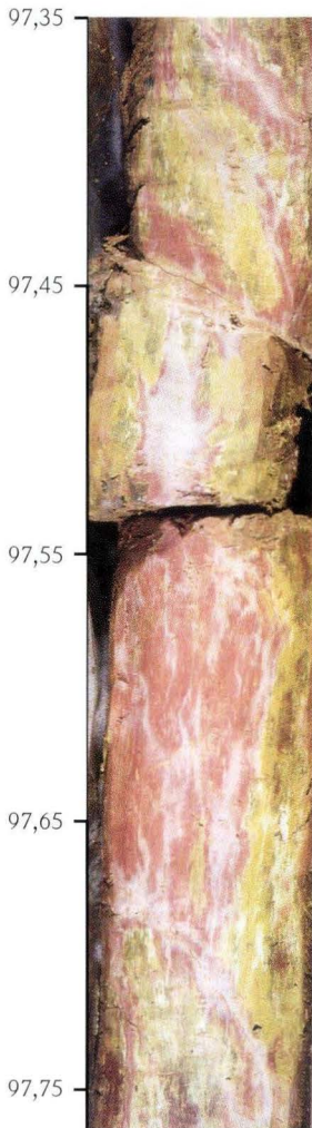
Abb. 6. Bohrung Wallau B98-BK5: 97,35–97,76 m: ockerbrauner Ton ( T_s ) durch Bodenbildung rot geflammt (UPS).
