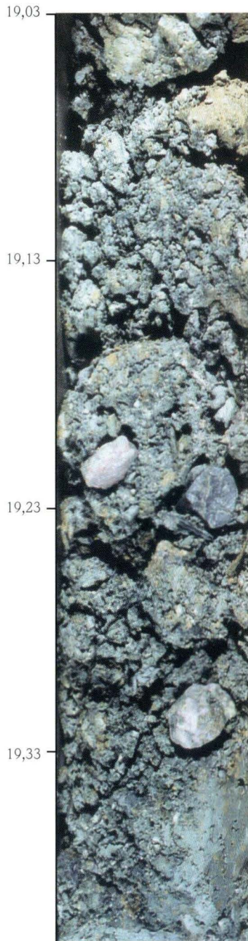
Abb. 11. Bohrung Wallau B98-BK5: 19,03–19,40 m: Kies ( K_T ), siltig, grün, mit Geröllen ( \varnothing bis 3–4 cm) aus Quarz, Quarzit, Metapelit (Phyllit) und Wiesbaden-Metarhyolith (Serizitgneis) (OPS).
