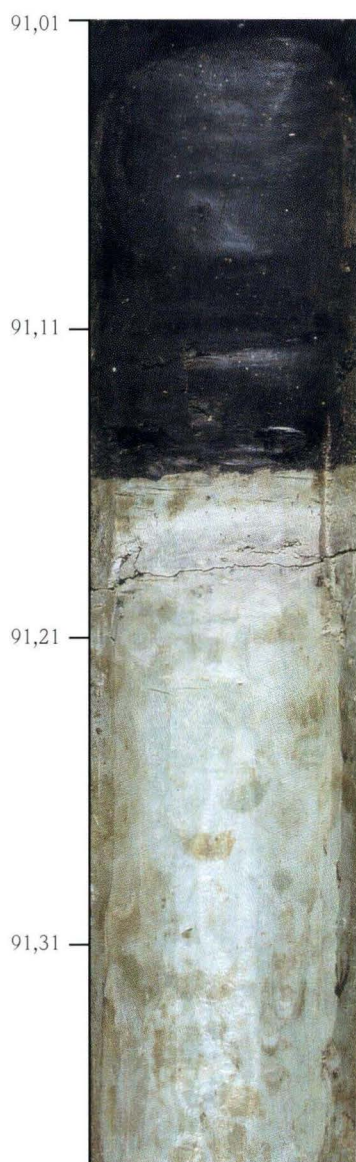
Abb. 5. Bohrung Wallau B98-BK5: 91,01–91,39 m: Scharfer Übergang zwischen Schwarzpelit ( T_f ) und Ton ( T_3 ) grün, braun fleckig (MPS).
