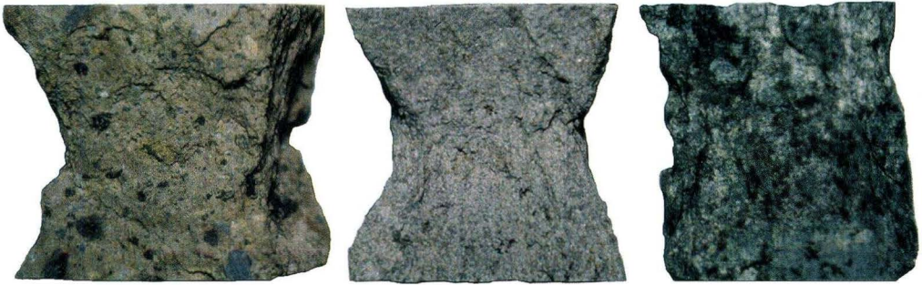
Abb. 23. Diagonal durch die Probekörper laufende Bruchstrukturen (von links nach rechts: Habichtswälder Tuffstein, Steinheimer Basaltlava, Holzhäuser Diabas); Originalhöhe der Probekörper: 5 cm.
