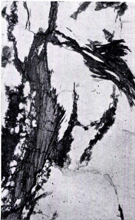
Abb. 51 (links). Stilpnomelan in einem quarzreichen Chlorit-Phyllit. Fundort: Linke Seite des Gräfenbachtals, etwa 160 m nördlich der Einmündung des Spaller Baches in den Gräfenbach. Bl. 6112 Wald-Böckelheim, R 340609, H 552057. Handstück-Nr.: 6223, Dünn-schliff-Nr.: 10560; ohne Nic.; Vergr.: 80 ×.
