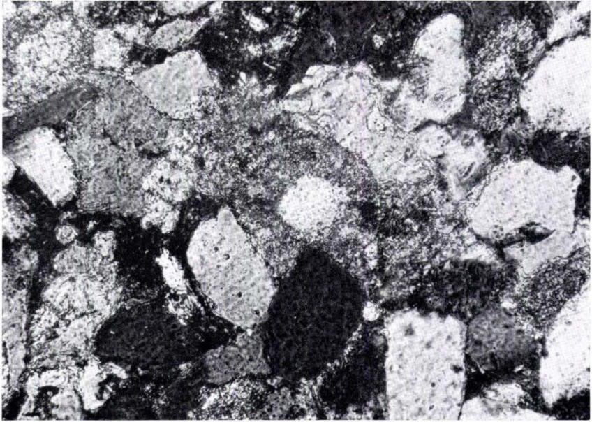
Abb. 11. Kalkooid (Calcit) von diagenetisch gewandertem jüngerem Calcit umgeben. — Quarzsandstein mit karbonatischem Bindemittel, Korbach-Folge (Unterer Buntsandstein). Fundort: Stbr. an der Reihermühle. Bl. 4720 Waldeck, R 349796, H 568932. Dünnschliff-Nr.: 6581, Handstück-Nr.: Kul 106. \times Nic.; Vergr.: 110 \times .
