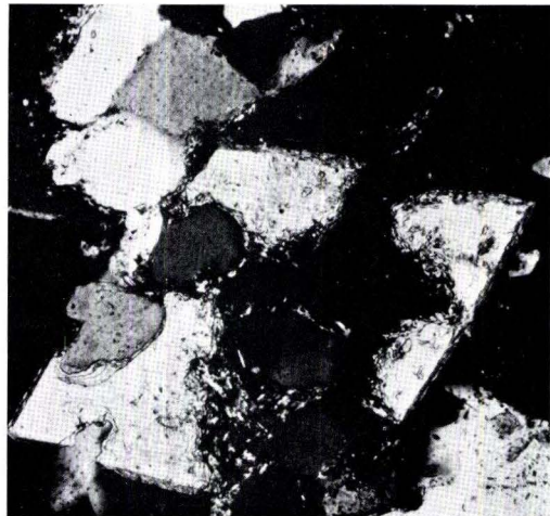
Abb. 12. Calcit-Einkristall umschließt und verdrängt zahlreiche detritische Quarz- und Feldspatkörner. — Quarzsandstein mit fleckig verteiltem Calcit-Bindemittel. Waldeck-Plattensandstein, Waldeck-Folge (Unterer Buntsandstein). Fundort: Profil Twiste am Burghardsberg, Bl. 4619 Mengeringshausen, R 349796, H 568932. Dünnschliff-Nr.: 6467, Handstück-Nr.: Kul 24a. \times Nic.; Vergr.: 110 \times .
