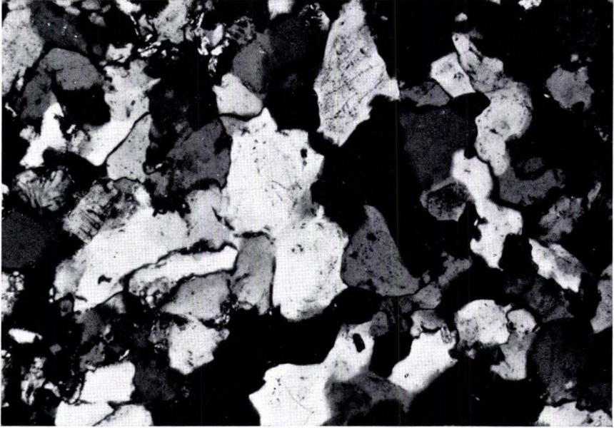
Abb. 7. Sedimentär-quarzitisches Gefüge, durch intensive Quarzauthigenese entstanden. — Quarzit, Röt-Folge (Oberer Buntsandstein). Fundort: Bahneinschnitt westl. P. 346,1 m, Zierenberg. Bl. 4621 Wolfhagen, R 35 22 26, H 56 92 46. Dünnschliff-Nr.: 6186, Handstück-Nr.: Rg 452. \times Nic.; Vergr.: 110 \times .
