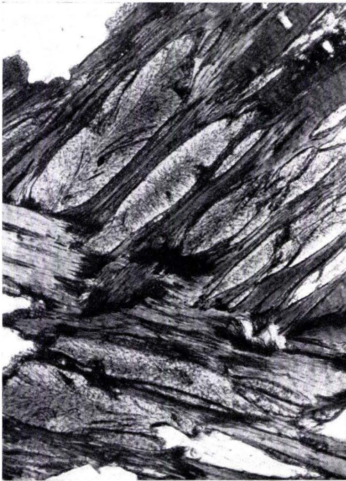
Abb. 25 (links). Linsenförmige Pumpellyit-Aggregate im Biotit, parallel zu (001) eingelagert. Granodiorit mit deutlicher Paralleltexur. Fundort: Straßenaufschluß a. d. Straße Fürth – Lindenfels, ca. 50 m hinter dem Felsensprudel in Richtung Lindenfels. Bl. 6318 Lindenfels, R 34 85 00, H 55 05 48. Handstück-Nr.: 4494, Dünnschliff-Nr.: 7907; ohne Nic.; Vergr.: 145 ×.
