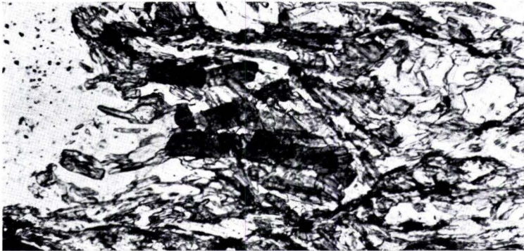
Abb. 66. Knaueartiges Aggregat von authigenen Schörlkristallen (dunkle Leisten) in einem Serizit-Chlorit-Phyllit der Lorsbacher Schieferfolge. Fundort: Walterstein, Bl. 5816 Königstein, R 3458 11, H 5554 86. Handstück-Nr.: St 11, Dünnschliff-Nr.: 3761; ohne Nic.; Vergr.: 200 ×.
