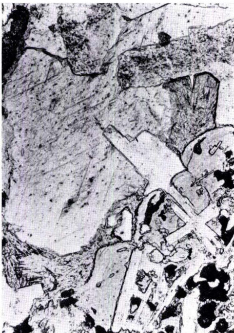
Abb. 22 (unten links). Pumpellyit (Doppel-Kristall, rechts) mit Calcit (Spaltrisse!) und Albit im interfragmentarischen Raum des Schalsteins. Fundort: wie Abb. 21; Handstück-Nr.: He 128, Dünnschliff-Nr.: 10317; ohne Nic.; Vergr.: 140 \times .
