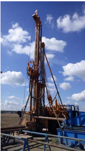
Abb. 4: links: Bohrgerät der 323 Meter tiefen Forschungsbohrung bei Riedstadt-Erfelden (nördlicher Oberrheingraben); rechts: Liner mit Bohrkern eines ein Meter-Segments von 143 bis 144 m der Forschungsbohrung. © HLNUG
