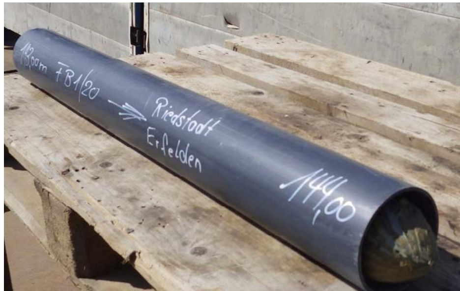
Abb. 4: links: Bohrgerät der 323 Meter tiefen Forschungsbohrung bei Riedstadt-Erfelden (nördlicher Oberrheingraben); rechts: Liner mit Bohrkern eines ein Meter-Segments von 143 bis 144 m der Forschungsbohrung. © HLNUG
