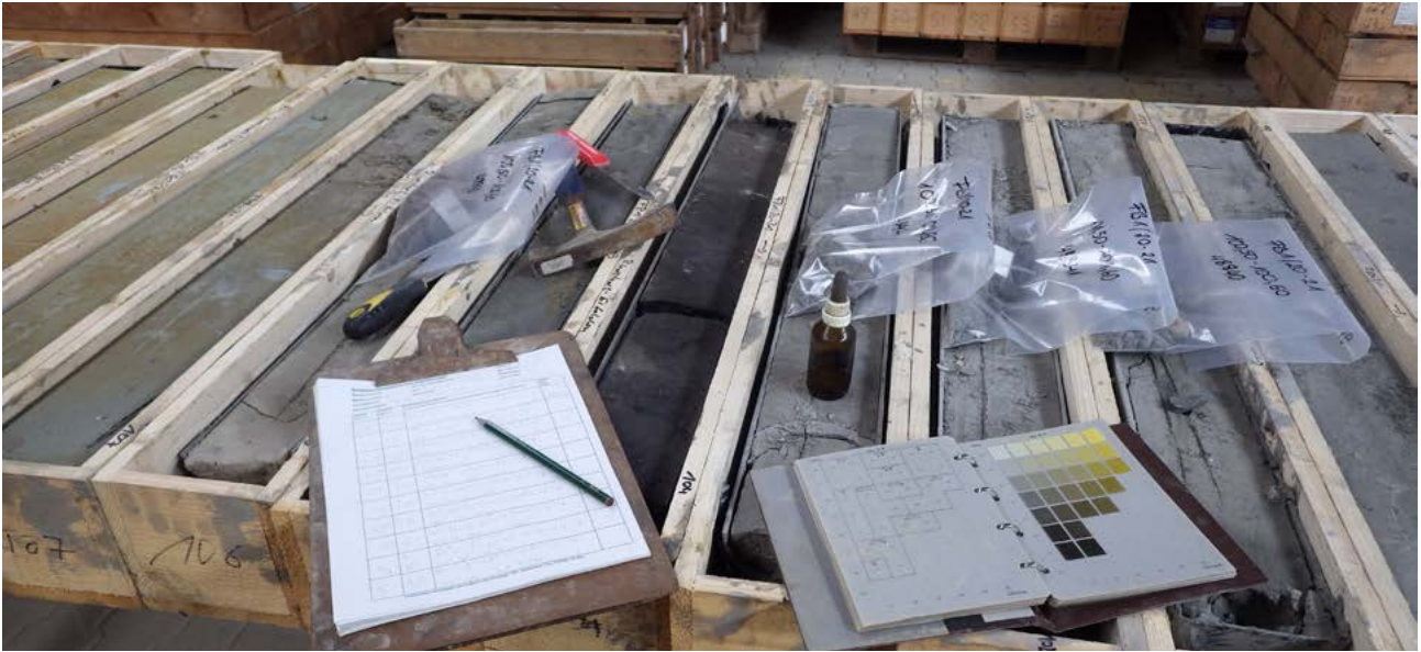
Abb. 5: Die halbierten Bohrkern der Forschungsbohrung Riedstadt-Erfelden werden im Bohrkernlager des HLNUG geologisch bearbeitet und für weitere wissenschaftliche Untersuchungen beprobt © HLNUG
