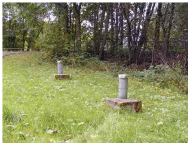
Abb. 67: Grundwassermessstellen in Ürzell, Muschelkalk in Kinzigtal.
