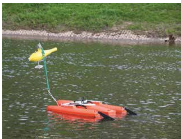
Abb. 19: Durchflussmessung mit mobilem Doppler Ultraschallgerät (ADCP).
