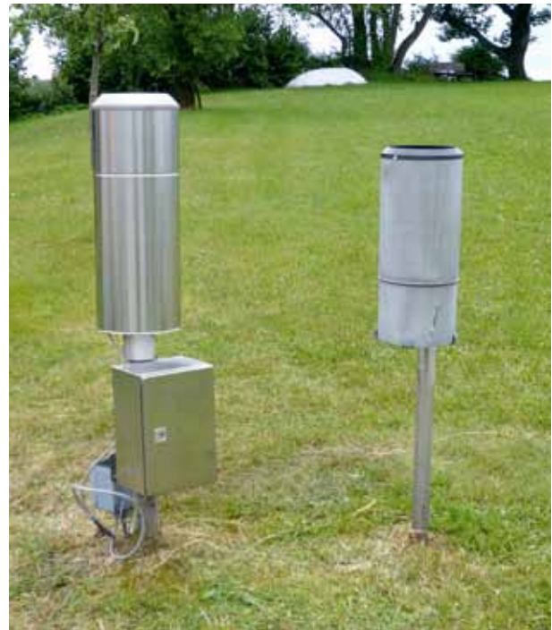
Abb. 4: Niederschlagsmessstelle Freiensteinau mit automatisch aufzeichnendem Messgerät mit Datenfernübertragung (Pluvio) (links) und Hellmann-Messer (rechts).
