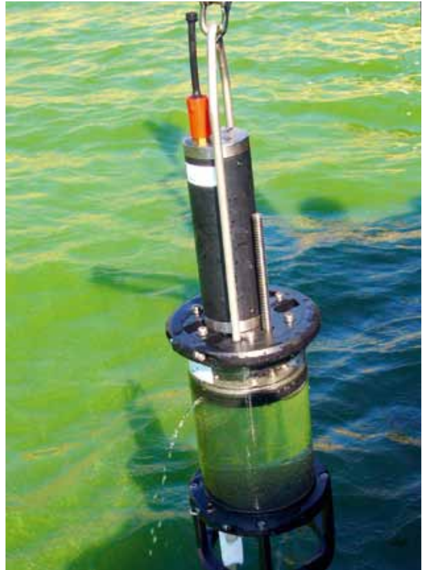
Abb. 36: Phytoplanktonprobe an der Diemeltalsperre mit kontinuierlich über die Wassertiefe messenden Wasserschöpfer.
