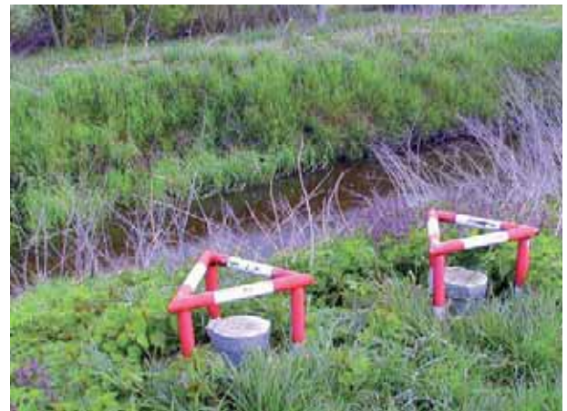
Abb. 38: Flache und tiefe Grundwassermessstelle in Worfelden, Hessisches Ried.
