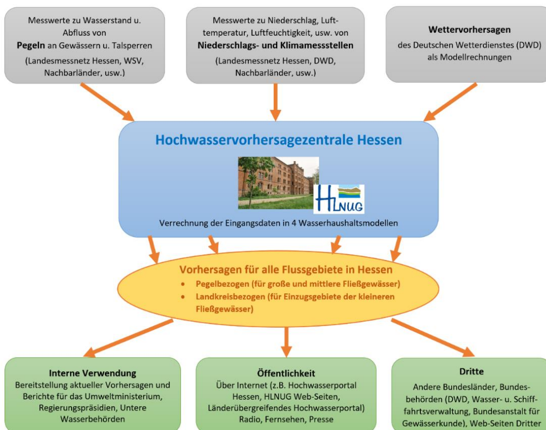
Abbildung 61: Datenflüsse für die Hochwasservorhersage, HLNUG
