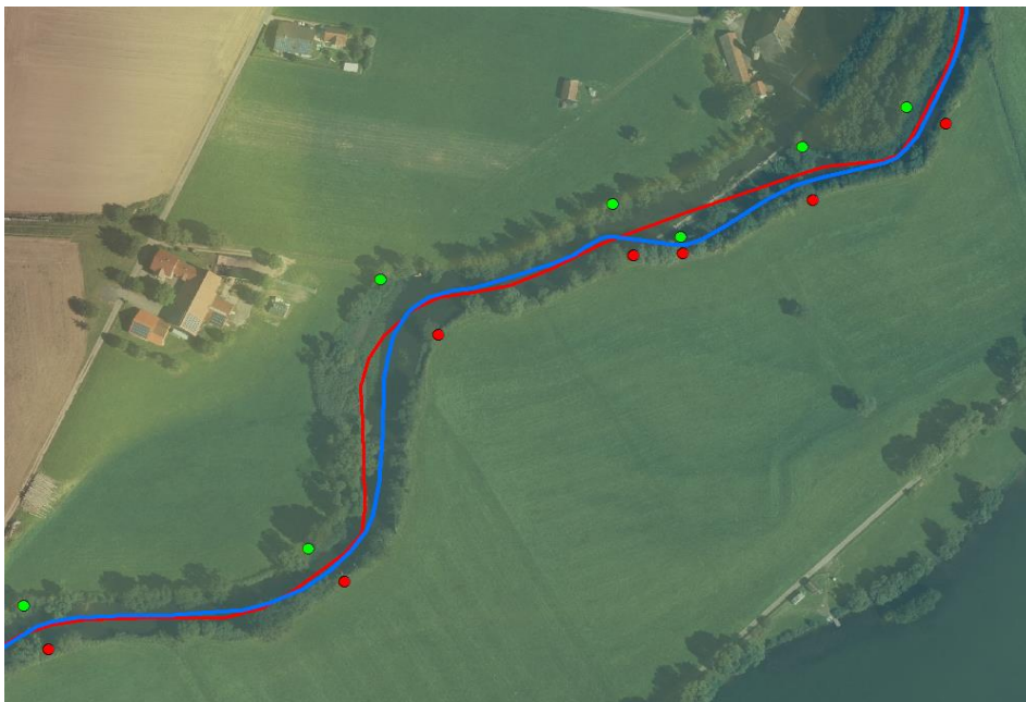
Abbildung 2-3: Optimierte Lage der Gewässerachse (rot: GewLinie_RHK; blau: optimierte Lage der Achse)
