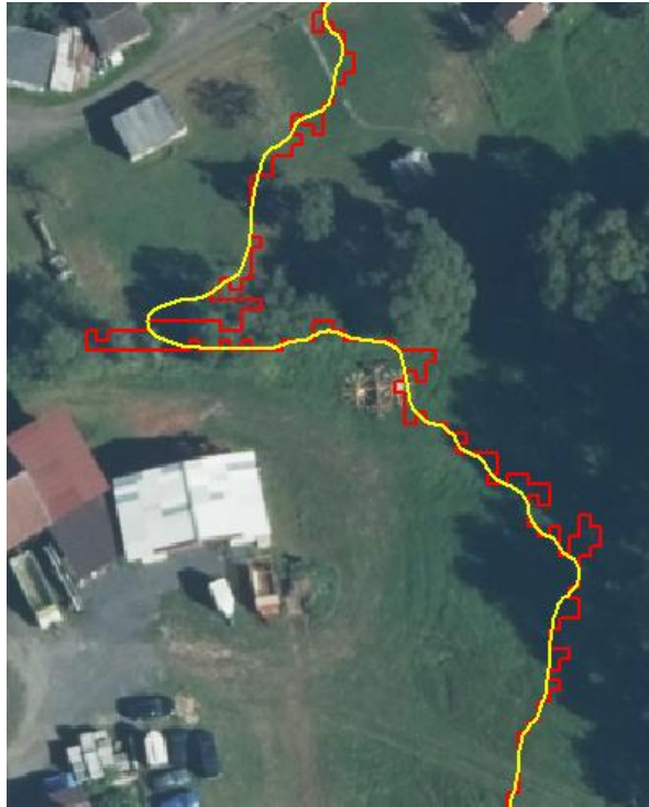
Abbildung 2-15: Originale (rot) und geglättete (gelb) Anschlaglinie des Wasserspiegels
