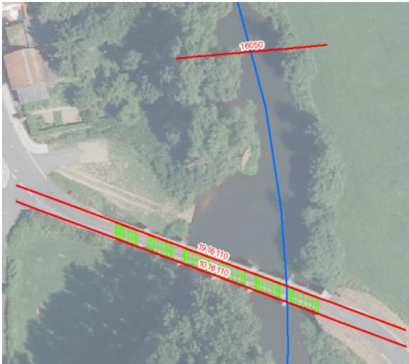
Abbildung 2-2: Einlaufprofil und kopiertes Auslaufprofil einer Brücke (Pfordter Str.)
