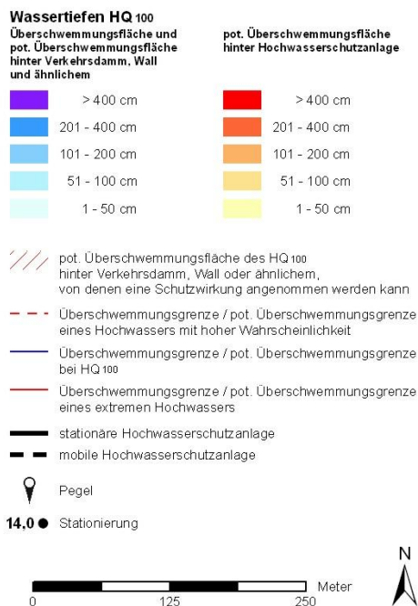
Abbildung 4.3: Legende der Hochwassergefahrenkarte
