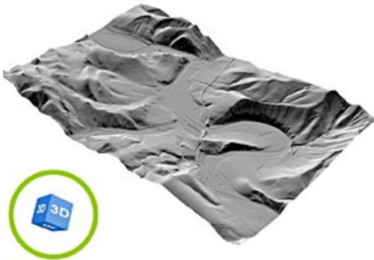
Abbildung 5: Durch Laserscanbefliegung generiertes Modell der Erdoberfläche (HVBG, 2020)
