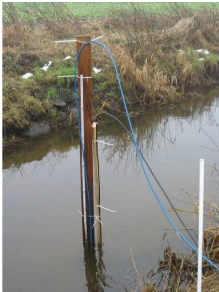
Lattenpegel in der Kielstau (Pegel K) mit Drucksensor
