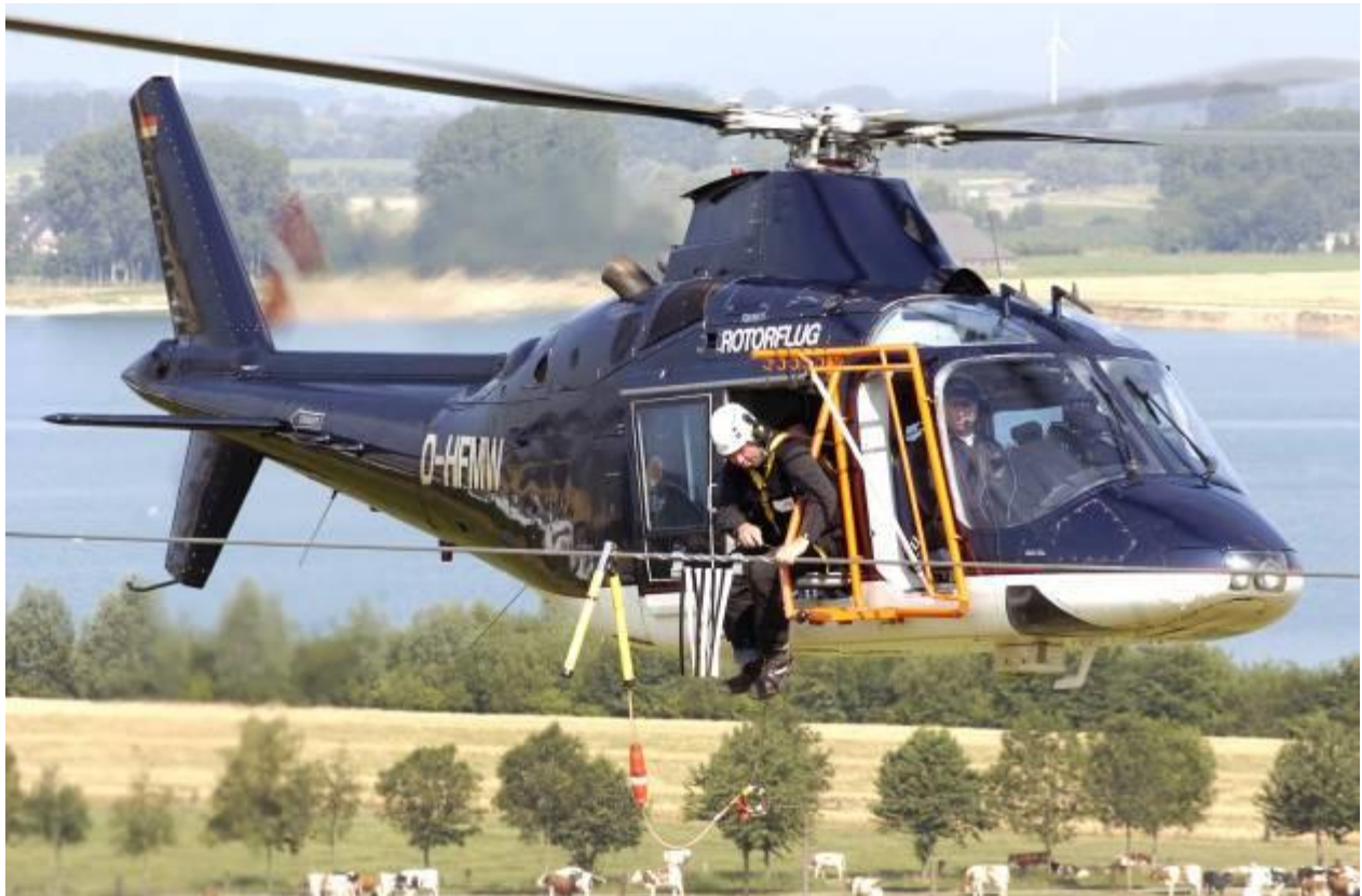
Abbildung 19: Markierung des Erdseils von Hochspannungsfreileitungen als effiziente Maßnahme zur Minimierung des Kollisionsrisikos (Foto: K. Richarz)
