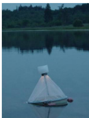
Abb. 4: Auftauch-Lichtfalle im Reichloser See. Foto: Verfasser
