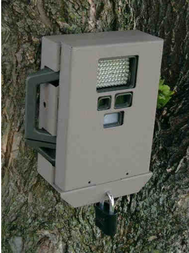
Abb. 6 Kamera in Stahlgehäuse, an Baum befestigt und mit Sicherheitsschloss versehen
