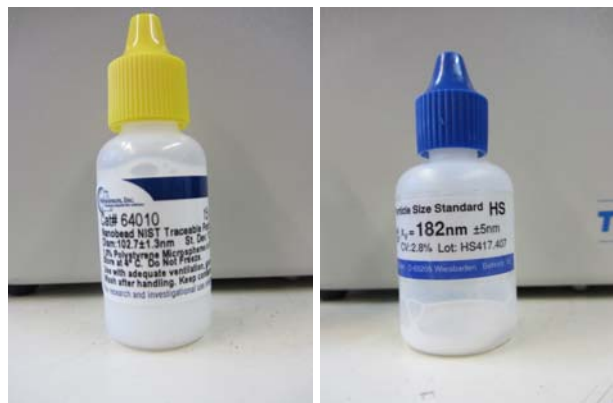
Abbildung 3: Polystyrol Latex Partikel PSL der Partikelgrößen 102,7 nm (Polysciences Inc., links) und 182 nm (BS-Partikel GmbH, rechts)
