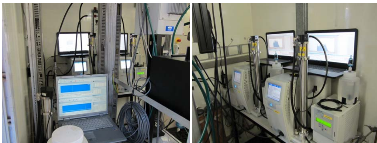
Abbildung 6: In die Messstation eingebaute SMPS für die Vergleichsmessungen
