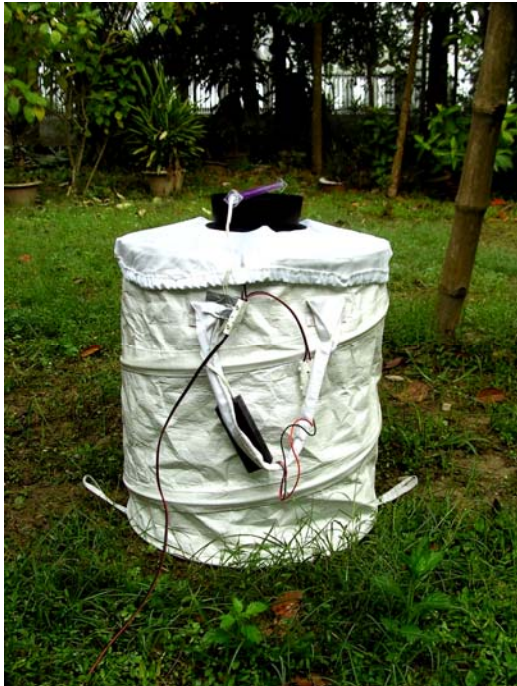
Abb. 5. BG-Sentinel-Lockstoff-Falle (Biogents AG, Regensburg), hier mit UV-Lichtquelle zum Fang von Gnitzen statt mit CO 2 -Quelle.
