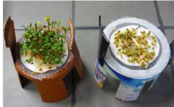
Abbildung 2: Versuchsanordnung beim Kresse-Keimungstest (links), Foto Testergebnisse (rechts)
