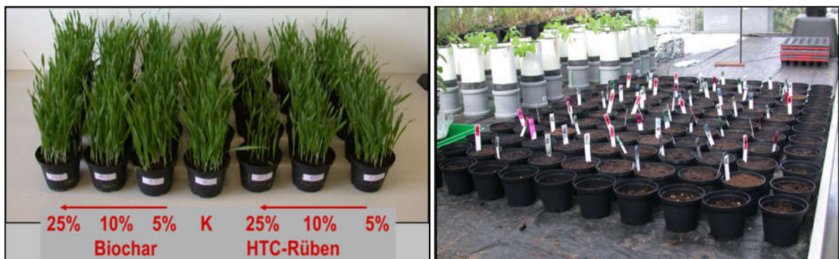
Abbildung 4: Gerstetest mit einem Biochar und einer HTC-Kohle (links), randomisierte Aufstellung mit Randgefäßen eines Testansatzes mit verschiedenen Biokohlen im Gewächshaus (rechts)
