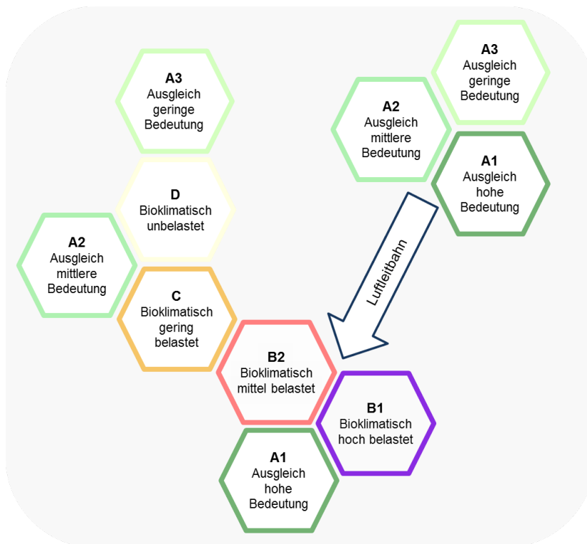
Abb. 1: Schematische Darstellung der Belastungs- und Ausgleichsräume (HLNUG 2019)
