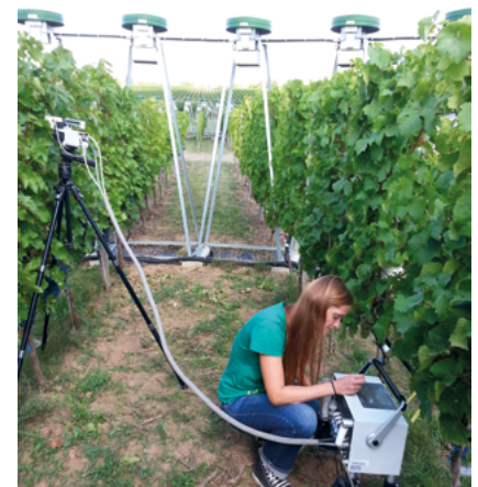
Gaswechselformung an Weinblättern der Sorte Riesling in einem FACE-Ring. Abgebildet ist M. Sc. Yvette Wohlfahrt bei der Messung. © Moustafa Selim
