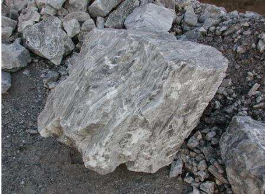
Abb. 2: Gipsrohstein (Kantenlänge ca. 30 cm) nach dem Lösen im Steinbruch. (Lagerstätte Witzenhausen-Hundelshausen)
