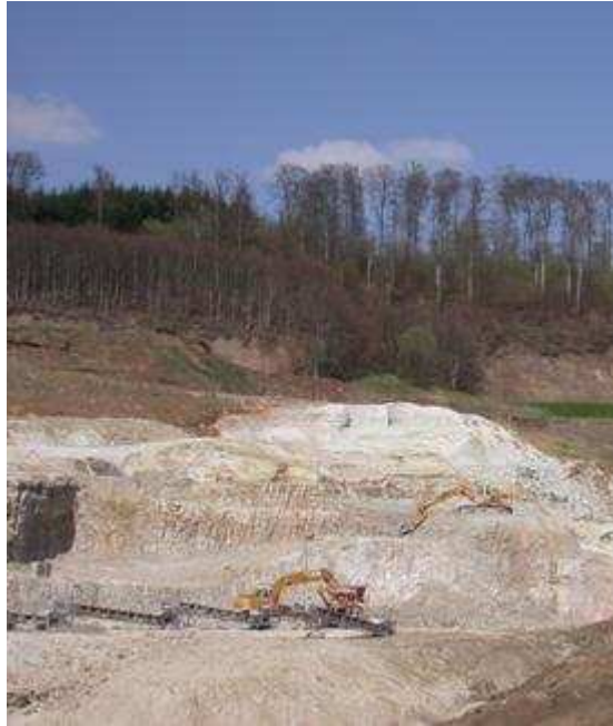
Abb. 4: Selektiver Abbau der unterschiedlichen Tonsorten einer Ton-Lagerstätte mittels Hydraulikbaggern und Transport per Bandanlage (Tagebau Wimpfsfeld, Mengerskirchen; Foto: HLUg, 2005)
