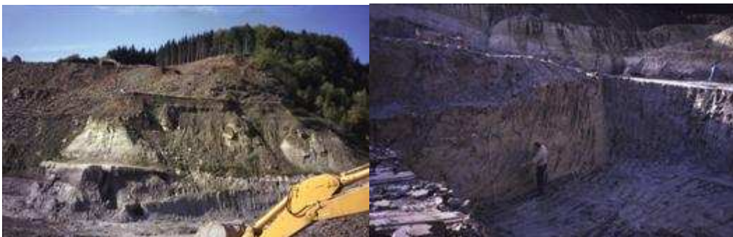
Abb. 8: Ton- und Quarzabbau unter überlagernden Basalt- und Tuffschichten in der Grube Stoß, Haiger-Langenaubach (Fotos: HLUg, 2000)
