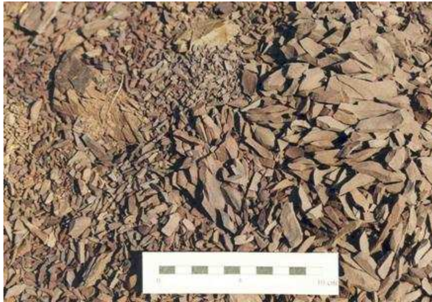
Abb. 15: Splittrig brechende Rotschiefer des Unterkarbons aus der Tongrube Sachsenberg, nördliches Rheinisches Schiefergebirge (Foto: HLUG).
