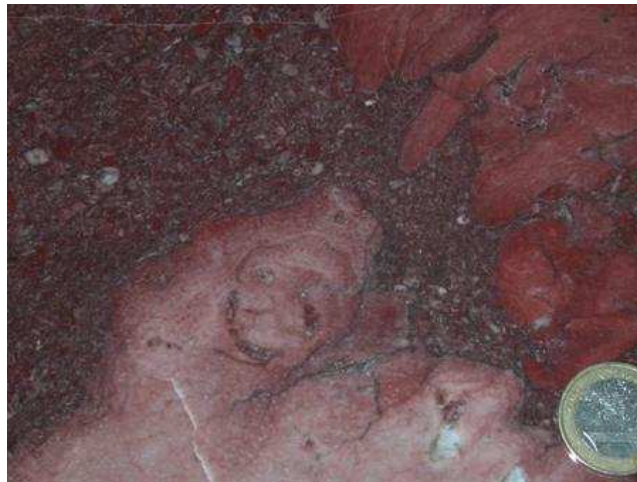
Abb. 3: Devonischer Massenkalk (Lahnmarble): Kalkstein mit Überresten von Koloniebildnern (Herkunft: Villmar; Handelsname: Unika [5])
