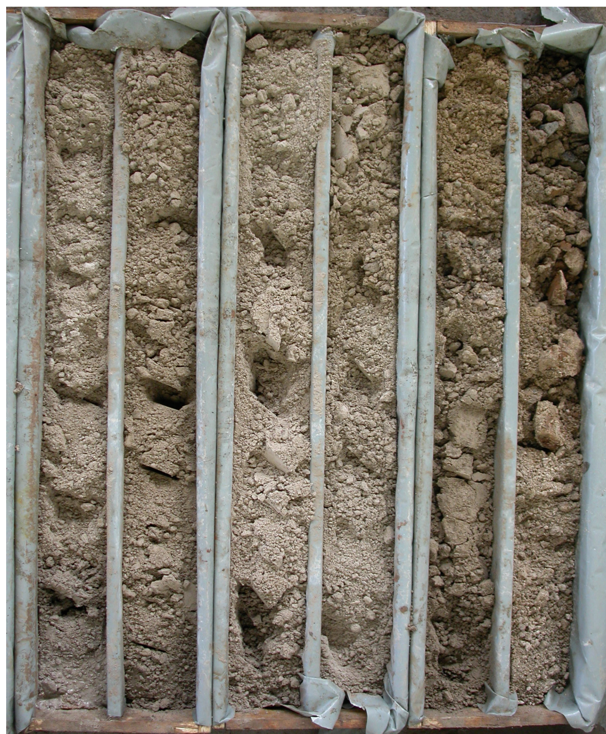
Vollständig veraschter Dolomit der Werra-Formation (z1) in einer Kernbohrung bei Hailer (rechts oben = Geländeoberfläche, links unten = Bohrtiefe 6 m)
