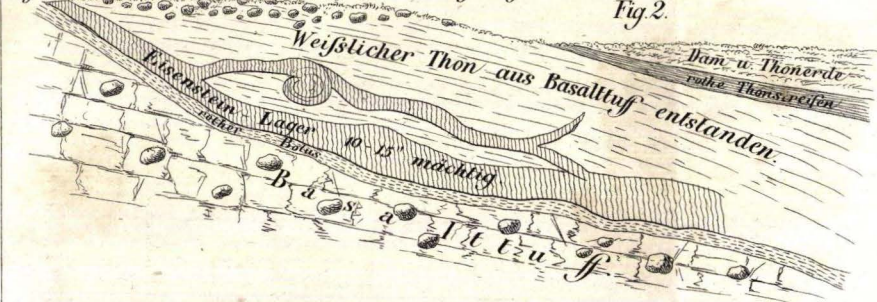
Längenprofil der Eisensteingrube „Wilhelm“ der Gewerkschaft Kiessling u. Comp. zu Hungen.
