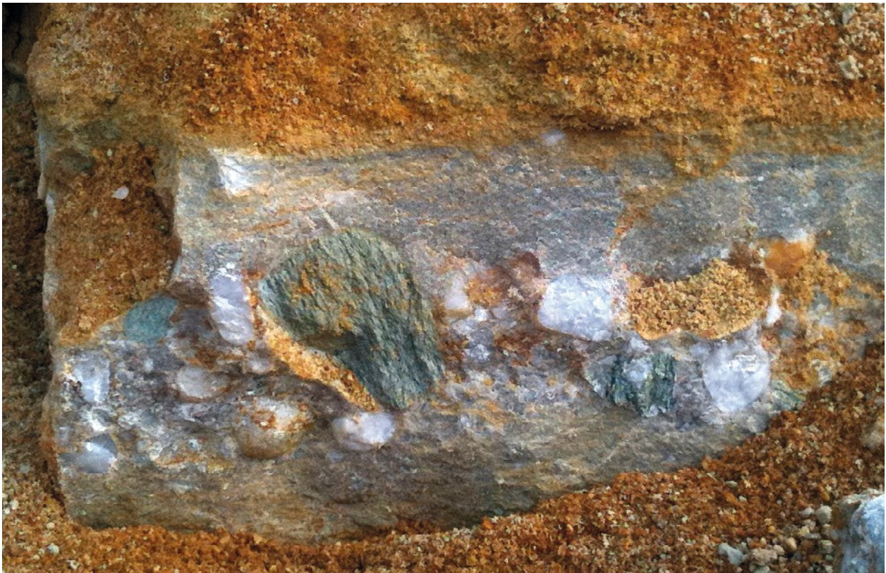
Abb. 3: Quarzitisches Konglomerat mit gut gerundeten Geröllen aus weißem Milchquarz (Gangquarze) und grünem, schiefrigem Metarhyolith (Ø ca. 25–30 cm), Baugrube Geisbergstr. 19 (2011).
