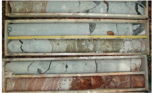
Abb. 15: Kernstrecke aus der Bohrung Sichenhausen-Rehberg von der Basis der Block- und Aschestrom-Ablagerung mit großen Trachyphonolith-Blöcken in einer trachyphonolithischen Matrix (106,0–110,1 m), über stark thermisch überprägten Surge-Ablagerungen (110,1–110,5 m) und basaltischen Aschentuffen (110,5–111,0 m). E-Hang Rehberg, ca. 20 m östlich Felsaufschluss in Abb. 6.
