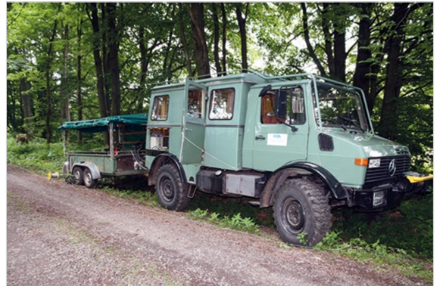
Abb. 5: Der Generator der Hochstromquelle war auf einem Anhänger montiert und wurde durch die Hydraulik eines Unimogs angetrieben. Die Steuerung erfolgte rechnergestützt aus der Kabine des Unimogs.
