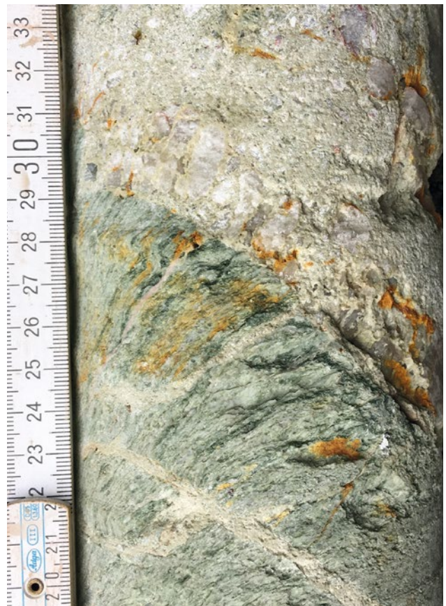
Abb. 8: Bohrkern BK 9/2011 (12,0–12,30 m): stark verfestigte – verkieselte – Basisgerölllage (Kalkfreie Randfazies, Tertiär) (bei 30 cm) auf Metarhyolith (Wiesbaden-Metarhyolith-Formation, Silur) (vgl. Abb. 1+9).
