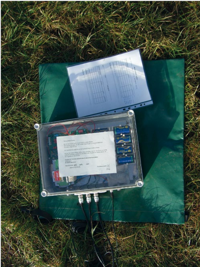
Abb. 2: Der Datenlogger Geolore mit einem zur Tarnung verwendeten Plastiksack.
