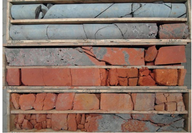
Abb. 19: Kernstrecke aus der Bohrung Bilstein mit typischer Basisbrekzie eines basanitischen Lavastroms (67,6–68,5 m) und deutlicher Kontaktwirkung (Rotfärbung) auf die liegende pyroklastische Abfolge (68,5–71,5 m). Im tiefsten Abschnitt ist die Topbrekzie des darunter folgenden Lavastroms erkennbar (71,5–72,0 m).
