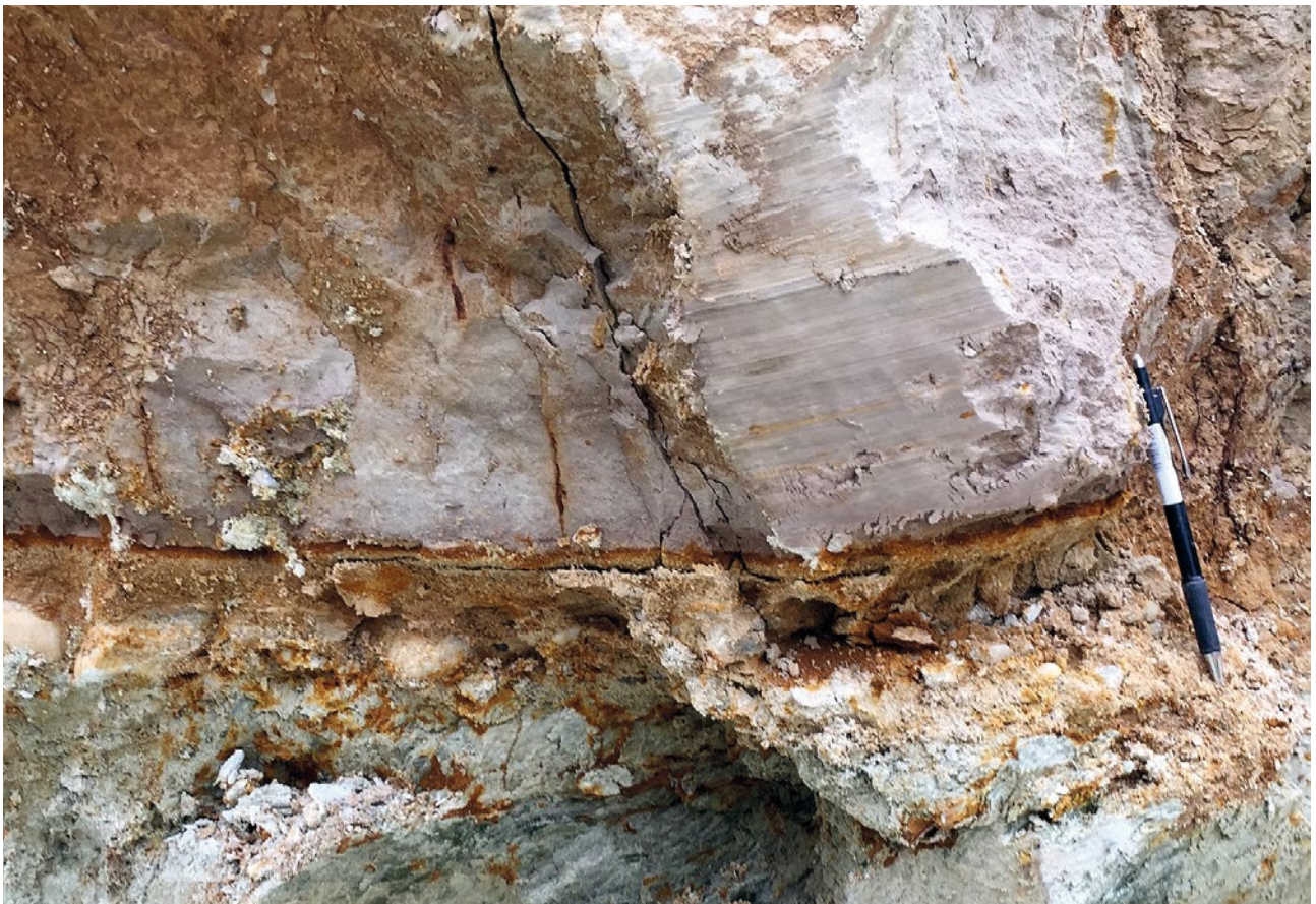
Abb. 7: Grenzbereich Kalkfreie Randfazies/Wiesbaden-Metarhyolith-Formation: violette, tonige Schluffe mit senkrecht angeordneten Pflanzenstängeln (braun) über eischüssigen Sanden mit gut gerundeten Milchquarzgeröllen (Basisgeröll) auf grünem, schiefrigem Metarhyolith (Baugrube Kureck).
