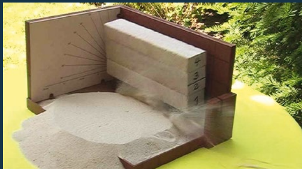
b: Wegziehen der Stützen
