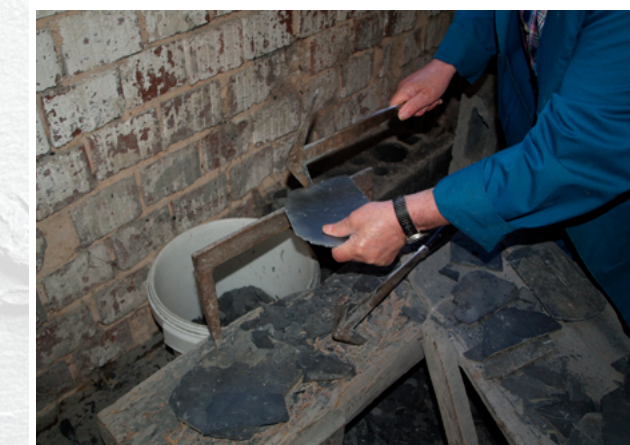
Bearbeitung von Schieferschindeln mit Spalteisen in 5 bis 8 mm dünne Platten im Besucherbergwerk Schiefergrube „Christine“ in Willingen
