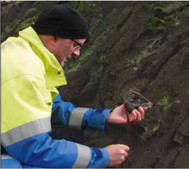
Abb. 7: Geologe Dr. Heggemann beim Einmessen von Neigung und Einfallrichtung der Gesteinsschichten mit dem Geologenkompass. Mit diesem Gerät können zwei Messungen in einem Vorgang durchgeführt werden. Zum einen kann der Neigungswinkel der in die Erde einfallenden Schichten gemessen werden, zum anderen wird die Richtung, in welche die Gesteinsschichten hin einfallen, bestimmt.
