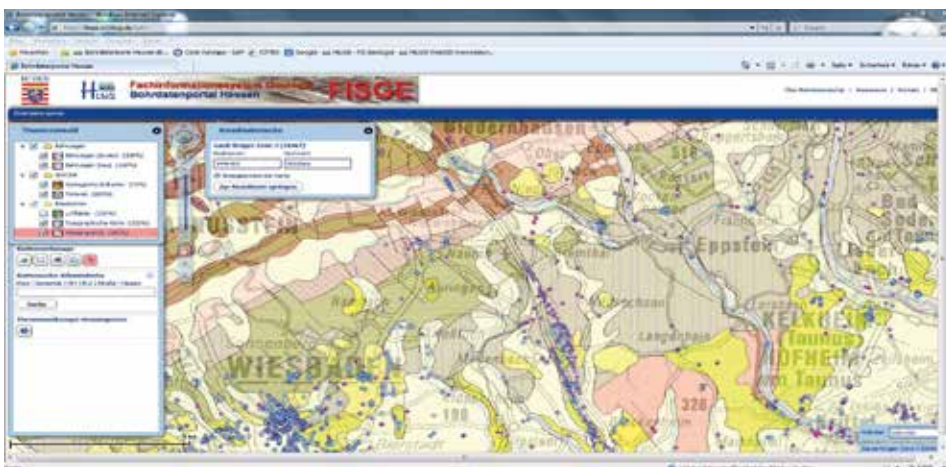
Abb. 13: Das Bohrdatenportal Hessen erlaubt dem Nutzer die Darstellung von Geologischer Karte und den in der Bohrdatenbank vorhandenen Bohrdaten.
