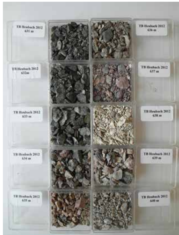
Abb. 12: Gesteinsproben aus der Bohrung Heubach: Das Bohrklein wird im Labor detailliert untersucht, um den Schichtenaufbau im Untergrund zu rekonstruieren. Bis 634m steht Biotitgneis an, darunter wurde Rhyolith erbohrt.
