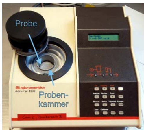
Abb. 13: Funktionsweise des Gasverdrängungs-Pycnometers, verändert nach (Micromeritics, 1997).
