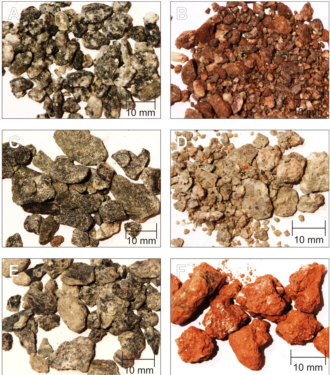
Abbildung 4.10 Bohrkleinaufnahmen von Proben aus der Teufe 115 m (A) 301 m (B), 353 m (C), 471 m (D), 716 m (E) und 732 m (F). Der Maßstab ist 10 mm.
