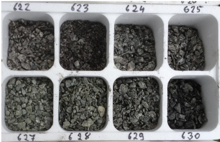
Bohrklein (Cuttings) aus der Spülung
