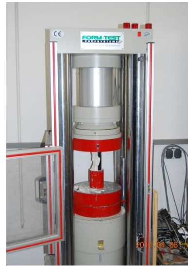
Abbildung 5.8: Prüfpresse zur Bestimmung der einaxialen Druckfestigkeit im Labor des IAG.
