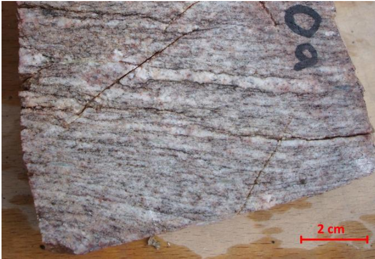
Abbildung 3.10: Anschliff eines leicht geschieferten Gneises, Probe Aufschluss 30.
