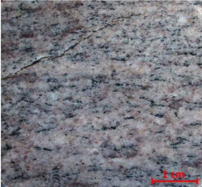
Abbildung 3.7: Anschliff eines Biotit-Gneises, Probe Aufschluss 16.
