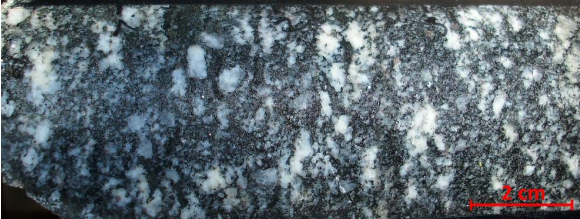
Abbildung 3.14: Anschliff eines Biotit-Chlorit-Hornblende-Gneises, Probe Aufschluss 26.
