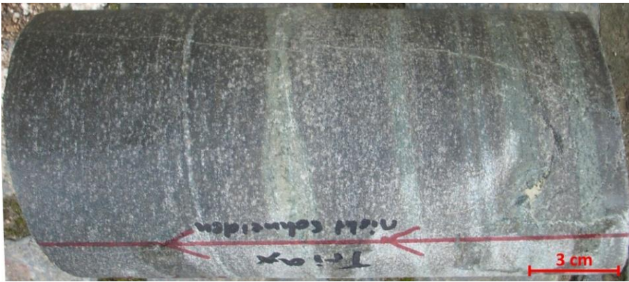
Abbildung 3.12: feinkörniger, dunkler, granatführender Biotit-Gneis; Bohrkern, Bohrung Heubach, oberer Kernabschnitt (613,3 – 617,8 m). Im mittleren Bereich des Kerns verläuft von oben nach unten ein boudiniertes, helleres Quarzband.
