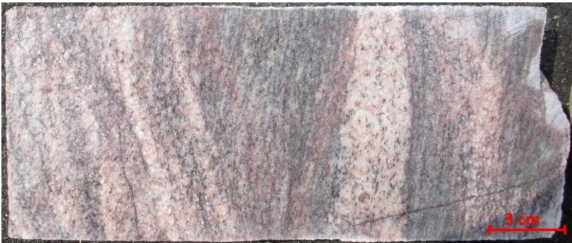
Abbildung 3.3: Anschliff eines Bändergneises, unterer Kernabschnitt Bohrung Heubach (772,8 – 774,9 m Teufe, EWS-2).
