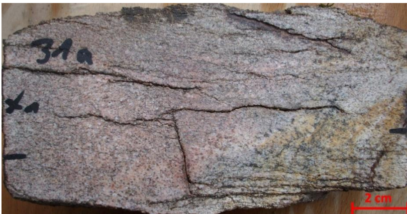
Abbildung 5.16: an Biotitlagen angreifende Verwitterung, Probe Aufschluss 31.
