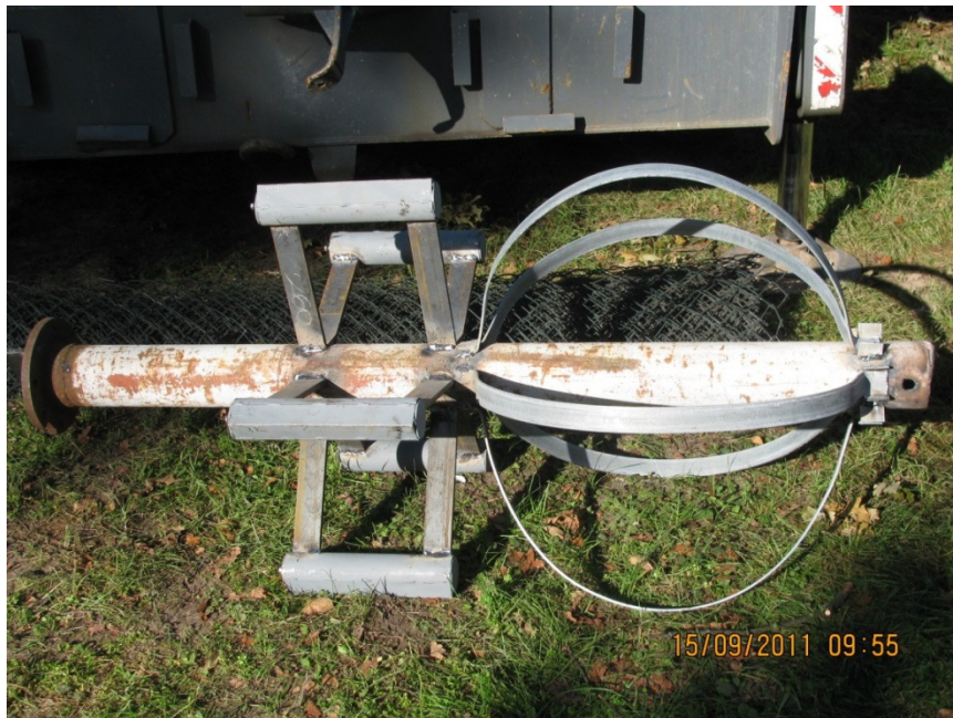
Sprengvorrichtung mit 5 Halterungen für die Sprengstoffladung im Abstand von 72°
