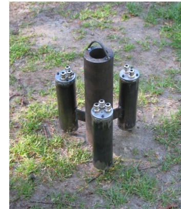
Sprengvorrichtung mit 3 horizontal versetzten Sprengstoffhaltungen
