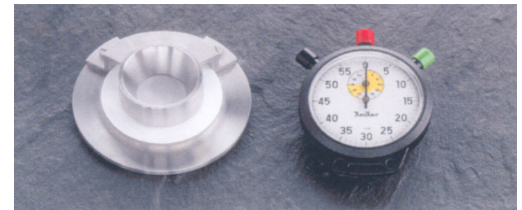
Ringapparat mit Stoppuhr zur Bestimmung der Wasserabgabezeit
