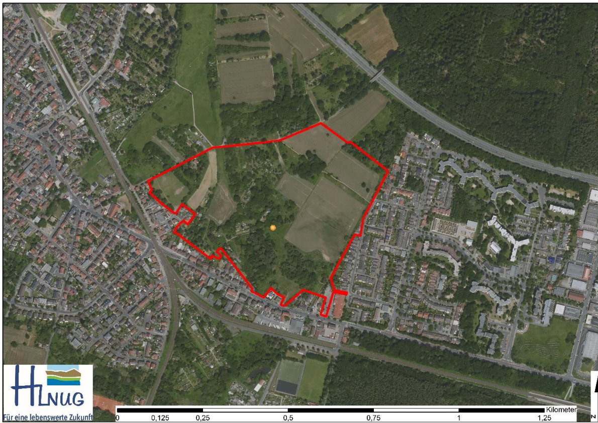
Abb. 1: Luftbild mit Geltungsbereich Baugebiet Waldhof West und Lage der Erkundungsbohrung (orange Punkt)
