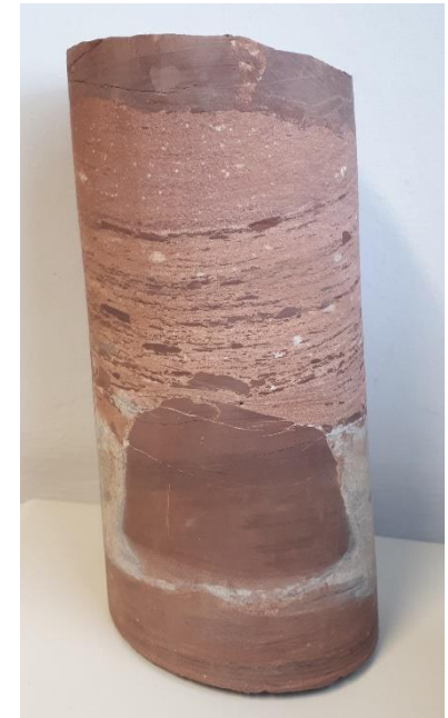
Mittlerer Buntsandstein mit Tonlagen, Bohrkern
