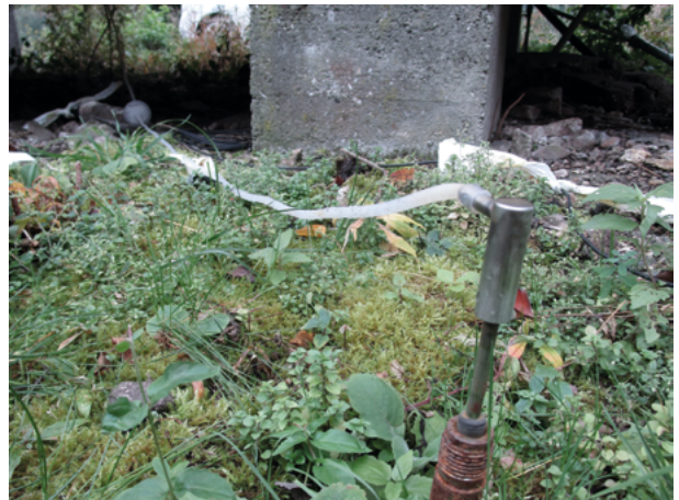
Abb. 2: Die Bodenluftsonde vor dem Messcontainer ist über einen flexiblen Schlauch mit dem Messgerät im Container verbunden
