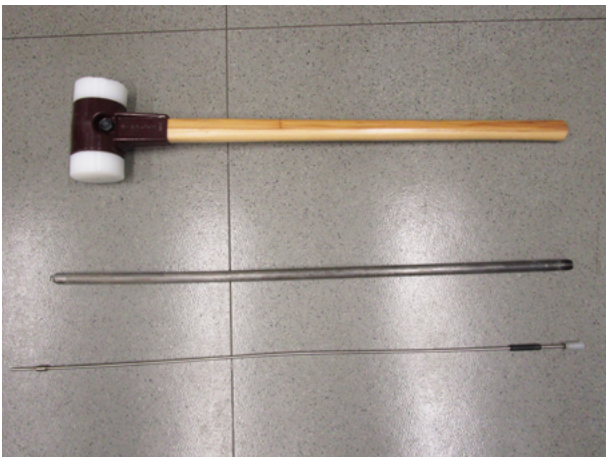
Abb. 3: Zur Messung von Bodenluft wird mit einem schweren Schonhammer (oben) ein dickes Außenrohr (Mitte) in den Boden geschlagen, in das ein dünnes Rohr (unten) zum Absaugen der Bodenluft eingeführt wird.
