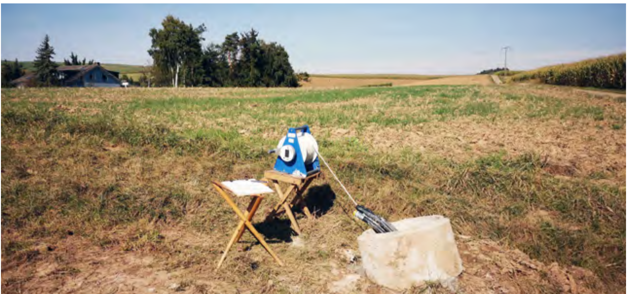
Abb. 1: Temperaturmessung in einer Erdwärmesonde, Wiesbaden-Nordenstadt
