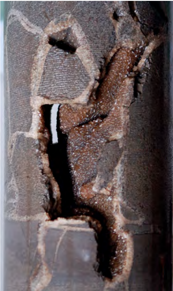
Abb. 6: Verkarsteter Kalkstein mit offenen Kluft- und Auslaugungshohlräumen und Verheilungsprozessen mit sekundären Kalzit-Rasen; Hydrobien-Schichten aus dem Untergrund im Vorfeld des Frankfurter Hauptbahnhofs
