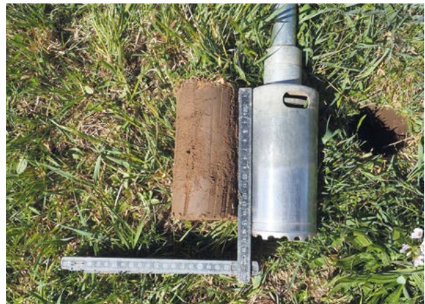
Abb. 4: Entnahme einer Einzelprobe mittels Murach'schem Wurzelbohrer © HLNUG
