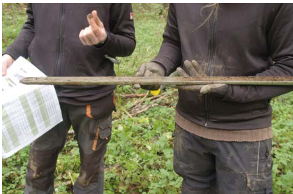
Abb. 5: Bodenkundliche Ansprache mittels Pürckhauerbohrung © HLNUG
